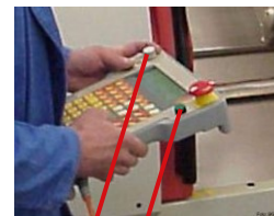
Zweistufiger Zustimmungsschalter und Not-Halt Befehlsgrad am PHG
